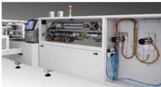
KBMフレームレスモータは、一般的なサーボモータよりもスループットが高く、低ノイズで長寿命を実現しています。キャンディマシンの例では、ギアボックス、タイミングベルト、プーリーなどの接合部品を不要として、システム効率を少なくとも10%向上させることができました。その結果、部品点数が減ることにより、マシンの信頼性が向上、マシンの組み立て時間も従来の3日間から4時間まで減らすことができました。このようにKBMフレームレスモータは、マシンに必要な性能を落とすことなく、部品点数を減らし、コストを下げるすることができます。
