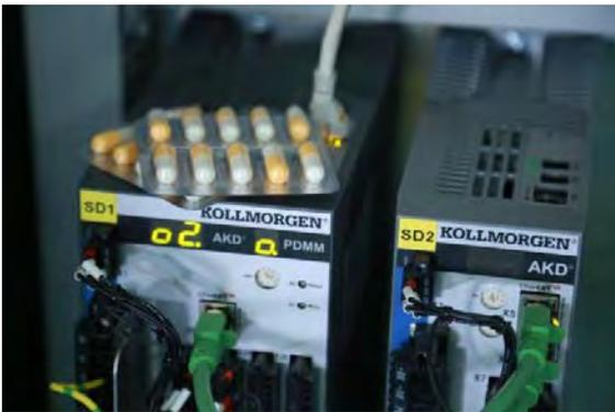
AKD PDMMは、高性能なPLC機能を備えたドライブベースのモーションコントローラで、高度なマシン制御を可能にしています。
